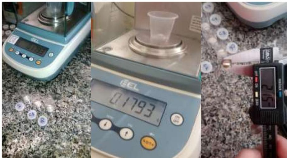
**Figuras 8 e 9:** Pesagem dos espécimes na balança analítica.
