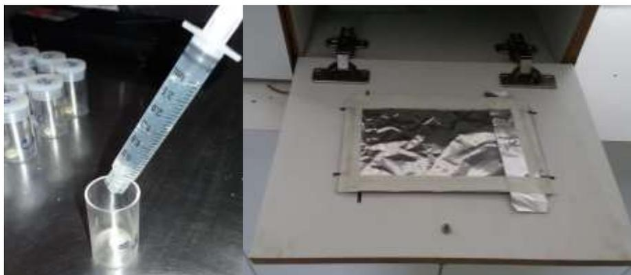
**Figura 11:** Seringa de 3 ml sendo utilizada para inserir água destilada nos potes j10 na quantidade de 3,3 ml.
