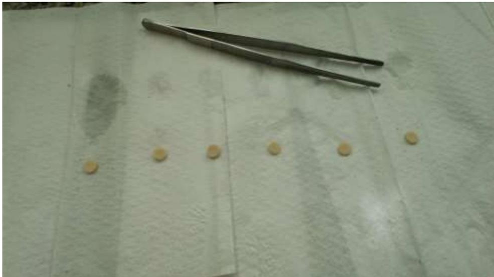
**Figura 13:** Remoção dos espécimes com pinça e secagem com papel absorvente.
