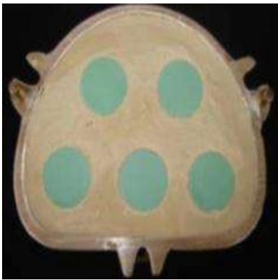
Figura 1. Padrões de silicone incluídos no gesso.
