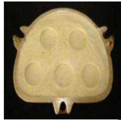
Figura 2. Orifícios deixados pelos padrões em gesso.
